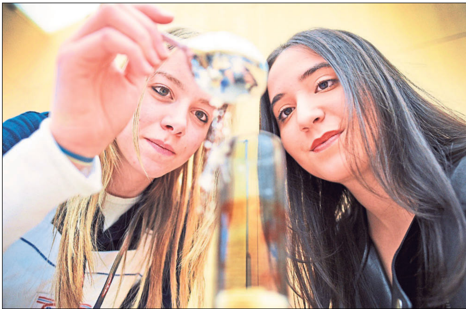
Der »Schüttraumtest« ist für Fachkräfte für Lebensmitteltechnik Alltag. Auszubildende Lisa Krause (links) demonstriert Besucherin Esra Turp, wie man 50 Gramm Mehl in einem Messkolben einfüllt und das Volumen misst – eine wichtige Qualitätsprobe. Foto: Thomas F. Starke
